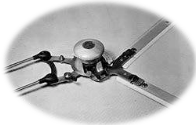
En af de første tegnemaskiner produceret i midten af 1940'erne med "hoved" af træ og skala af celluloid. NTI-tegnemaskine model VM 60 var den mest solgte model og blev produceret helt frem til 1990.
